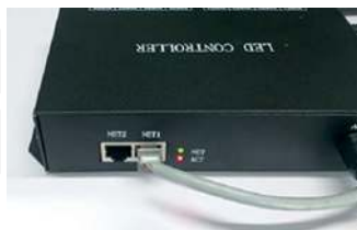
Рис. 2. Подключение контроллера HX-801RC к мастер-контроллеру или компьютеру.
