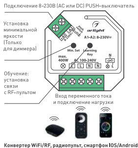
Рис. 1. Назначение кнопок и входов подключения.
