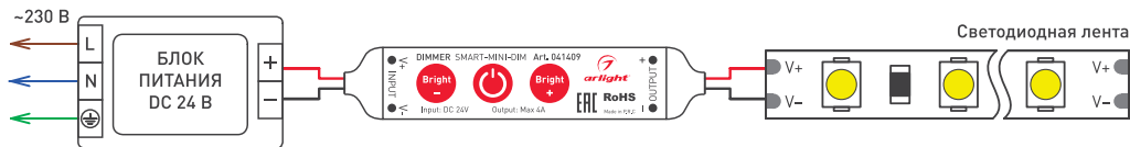
Рисунок 1. Схема подключения диммера SMART-MINI-DIM
