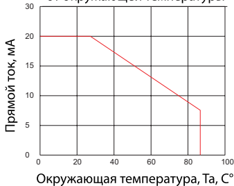
Зависимость прямого тока от окружающей температуры
