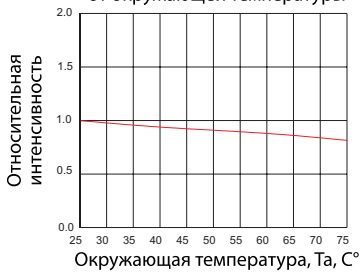
Зависимость относительной интенсивности от окружающей температуры
