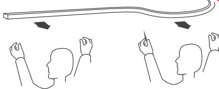
Монтаж и демонтаж отрезков «неона» длиной более 2 метров обязательно производить вдвоем
