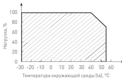
Рис. 4. Максимальная допустимая нагрузка, % от мощности источника
