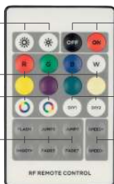
Рисунок 3. Назначение кнопок на пульте ARL-4022-RGBW White
