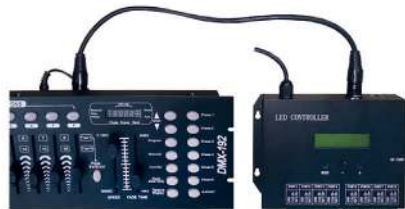
Рис. 4. Подключение DMX-консоли для управления контроллером.
