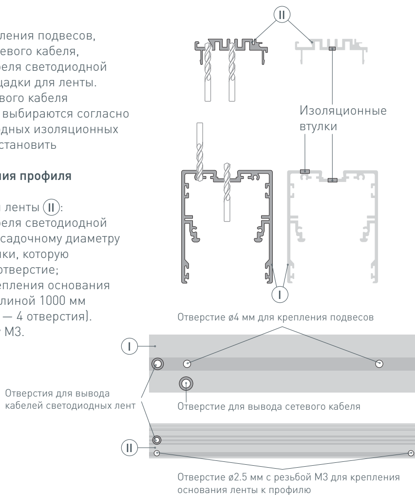
Рисунок 1. Профиль Ⓘ и основание для ленты Ⓜ , вид сверху
