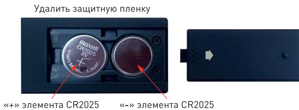
Рис. 1. Установка элемента питания.
