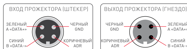
Цоколевка коннекторов на сигнальных кабелях
