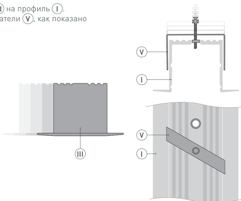
Рисунок 1. Профиль с держателем, вид сверху
