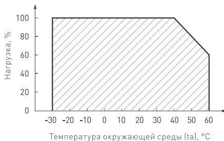
Рис. 2. Максимальная допустимая нагрузка, % от мощности источника
