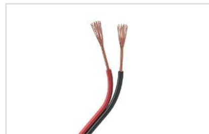
Артикул 026349 Шлейф для питания и управления одноцветными светодиодными лентами. 2 проводника, калибр проводника 20AWG, сечение проводника 0.52 мм 2 , материал проводника - лужёная медь.
