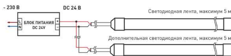
Рисунок 2. Схема подключения лент к источнику питания при температуре окружающей среды более +40 °С.
