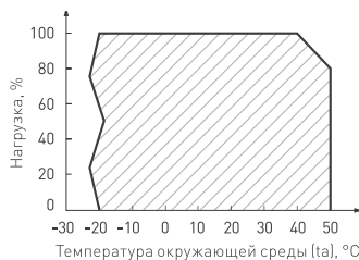
Рис. 3. Максимальная допустимая нагрузка, % от мощности источника
