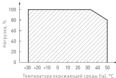
Рис. 2. Максимальная допустимая нагрузка, % от мощности источника
