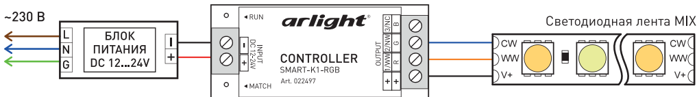
Рис. 2. Подключение светодиодной ленты MIX (CCT).
