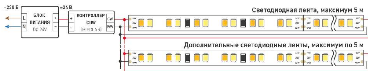
Схема 2. Подключение нескольких светодиодных лент с двух сторон.
