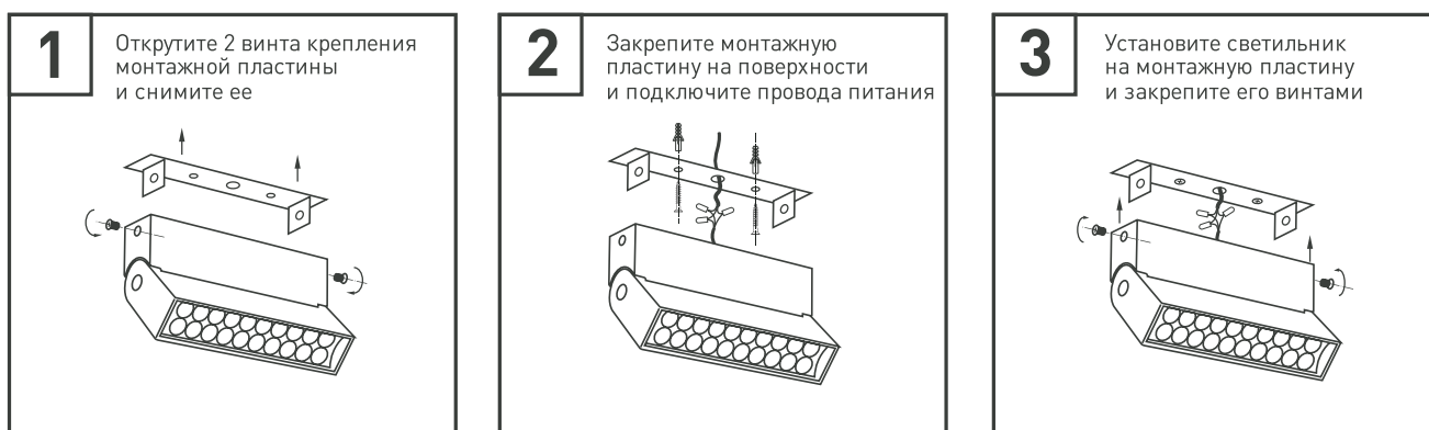
Рис. 2. Установка и подключение светильника
