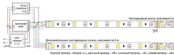
Схема 1. Подключение нескольких светодиодных лент с одной стороны.
