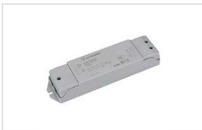
Артикул 025029 Диммер TRIAC для светодиодных лент. Сигнал управления TRIAC 40-220VAC, питание/рабочее напряжение 12-48VDC, максимальный ток 15A, максимальная мощность 180-720W. Винтовые клеммы.
