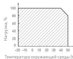
Рис. 3. Максимальная допустимая нагрузка, % от мощности источника
