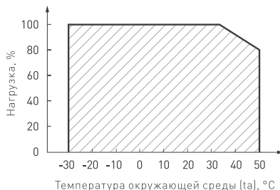
Рис. 2. Максимальная допустимая нагрузка, % от мощности источника
