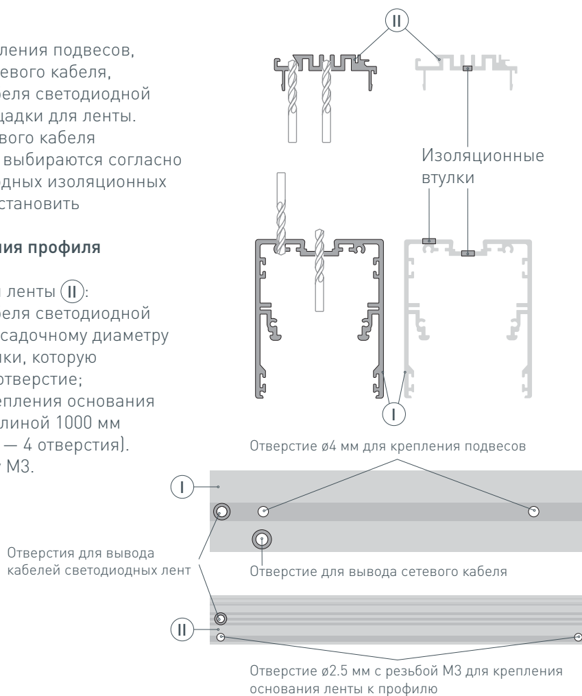
Рисунок 1. Профиль Ⓚ и основание для ленты Ⓚ , вид сверху
