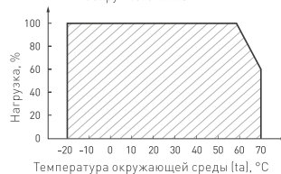
Рис. 4. Максимальная допустимая нагрузка, % от мощности источника
