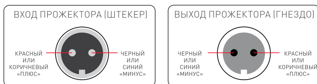
Цоколевка коннекторов на кабелях питания
