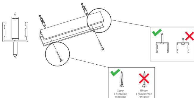
Выбирайте крепеж согласно рекомендациям. Диаметр крепежного отверстия — 3,5 мм. Максимальный диаметр головки шурупа — 6 мм. Используйте шурупы с потайной головкой.
