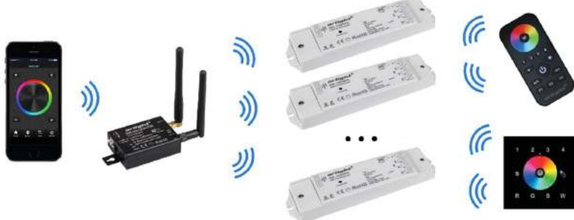
Рис. 1. Прямое подключение мобильного устройства к конвертеру (без использования домашней сети).
