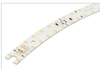
027648 SL-ARC-D800-A45-5.8W 24V Day4000 (320мм, дуга 1 из 8)
