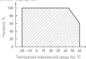
Рис. 1. Максимальная допустимая нагрузка, % от мощности источника
