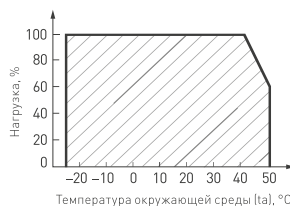
Рис. 2. Максимальная допустимая нагрузка, % от мощности источника
