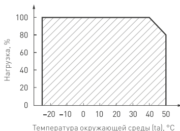
Рис. 2. Максимальная допустимая нагрузка, % от мощности источника
