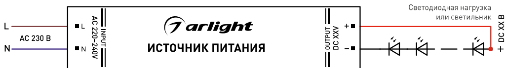
Рис. 1. Пример подключения источника питания
