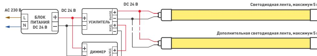
Схема 2. Подключение светодиодных лент «неон» с возможностью изменения яркости
