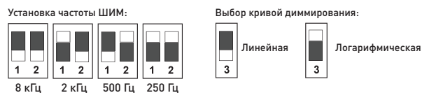
Рисунок 2. Положения DIP-переключателей
