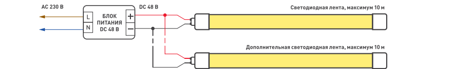
Схема 1. Подключение нескольких светодиодных лент «неон» с одной стороны
