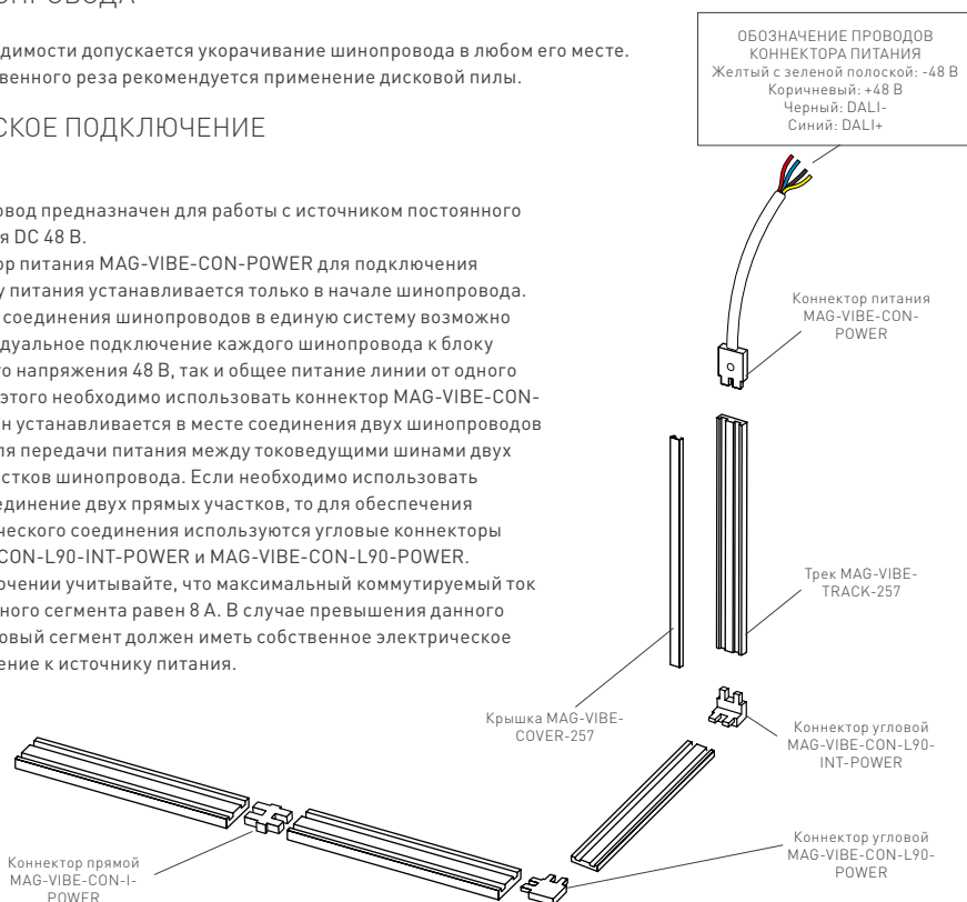
Рис. 2. Элементы и принцип построения разветвленной системы
