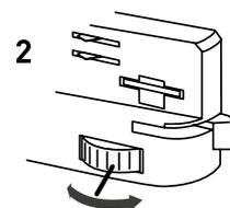
Рис. 2. Установка светильника в трек
