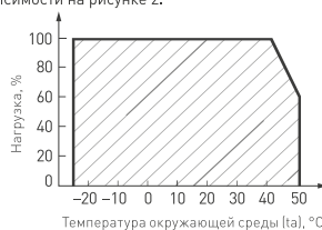
Рис. 2. Максимальная допустимая нагрузка, % от мощности источника
