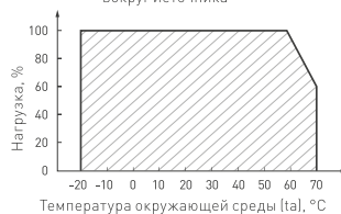
Рис. 4. Максимальная допустимая нагрузка, % от мощности источника
