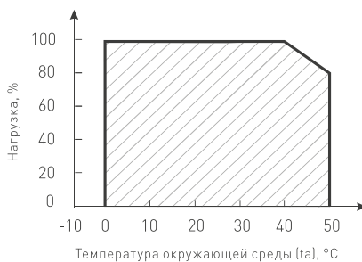
Рис. 2. Максимальная допустимая нагрузка, % от мощности источника
