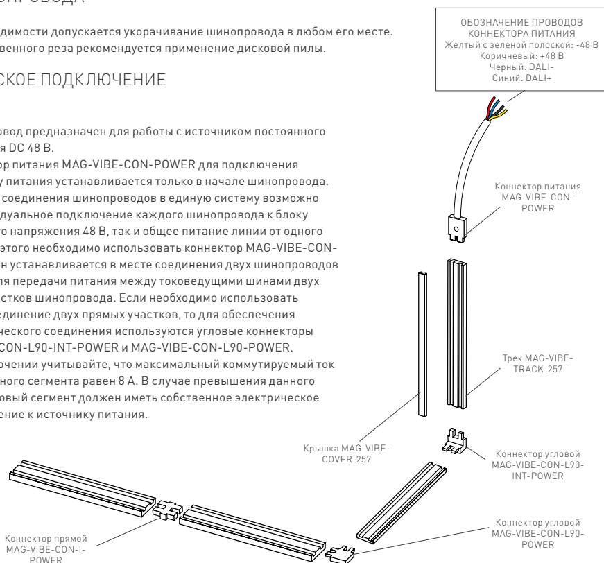
Рис. 2. Элементы и принцип построения разветвленной системы
