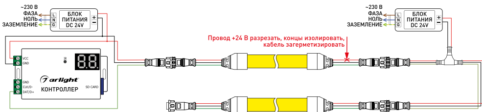
Рис. 2. Схема подключения питания с использованием двух источников напряжения
