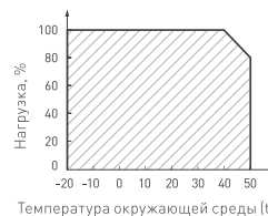
Рис. 3. Максимальная допустимая нагрузка, % от мощности источника
