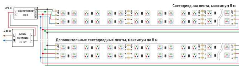
Схема 2. Подключение нескольких светодиодных лент с двух сторон. Рекомендуется использовать для обеспечения равномерного свечения ленты по всей длине.
