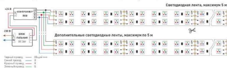
Схема 1. Подключение нескольких светодиодных лент с одной стороны.
