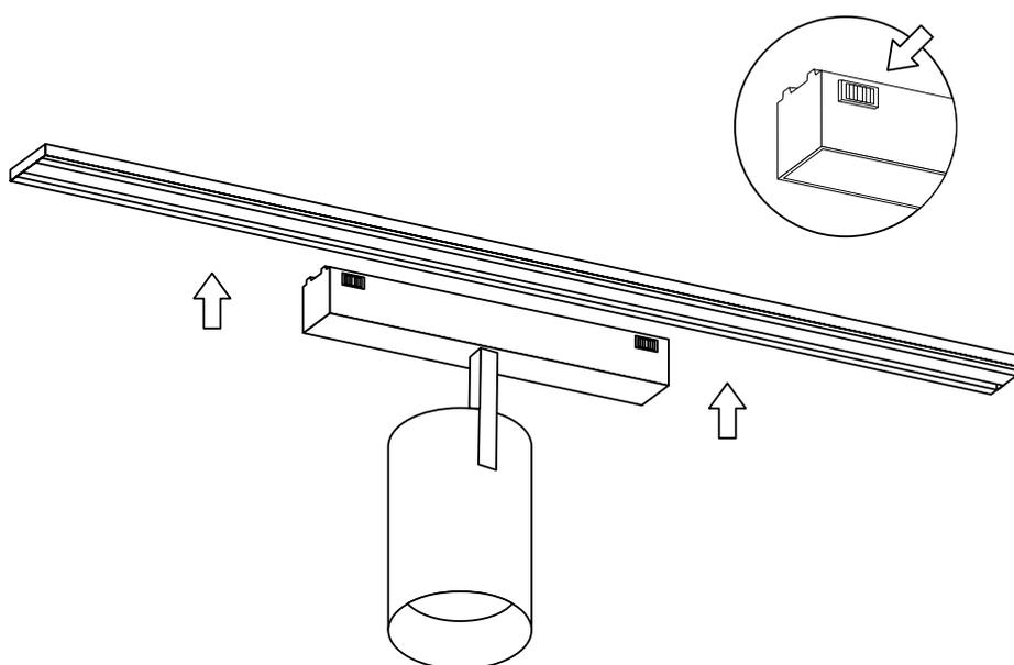
Рис. 2. Установка светильника
