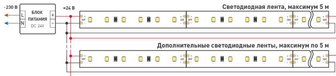
Схема 1. Подключение нескольких светодиодных лент с одной стороны.
