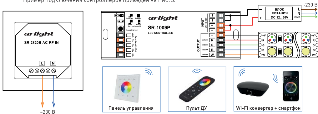
Рис. 3. Схема подключения оборудования на примере контроллера SR-1009P.
