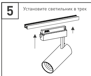
Рис. 2. Установка и подключение светильника
