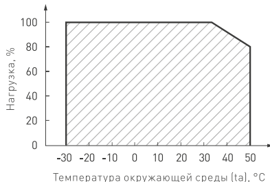
Рис. 2. Максимальная допустимая нагрузка, % от мощности источника
